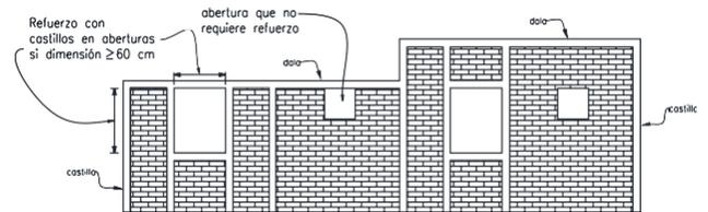
Figura 5.7.2 Refuerzo en el perímetro de aberturas
